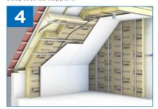
Coupez les fourrures Stil® F530 à H-1 cm et les emboiter dans les rails tous les 60 cm ou 40 cm si le mur est destiné à être carrelé.
