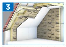
Coupez l'isolant à H+2cm, l'embrocher sur les appuis Rénovation Stil® F530. Coupez les tiges des appuis en fonction de l'épaisseur de la laine et placez les cavaliers sur les tiges.
