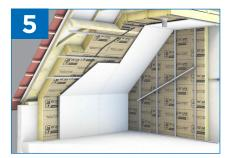
Réglez l'aplomb de chaque fourrure à l'aide d'une règle de 2 mètres et verrouillez la clé d'appuis en effectuant 1/4 de tour dans le sens des aiguilles d'une montre.
