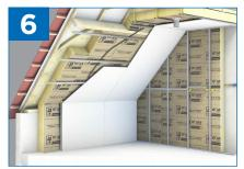
Placez les Connector Optima<sub>2</sub> ISOVER sur les fourrures verticales à 1,30 cm du sol et clipsez-y les entretoises préalablement découpées à 56 cm.
